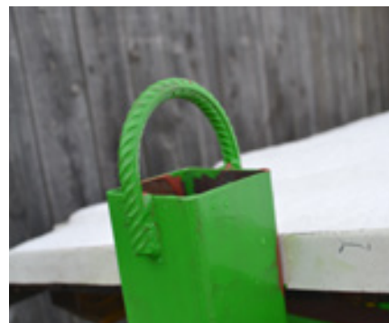
Nosilec za kavelj in s tem možnost dviga čebelnjaka. Foto: Uroš Šonc
